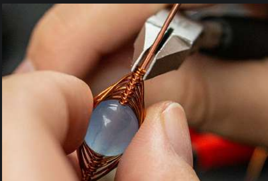
12. A kleštěmi ho pevně stlačíme k drátu vodícímu. Měď je měkká, proto se nám na vodící drát hezky uchytne. Tím jsme upevnili drát omotávací.
