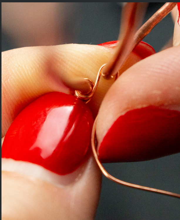
12. Potom vedte drátek na druhý ohyb rovného drátu, oviňte a vraťte se.
